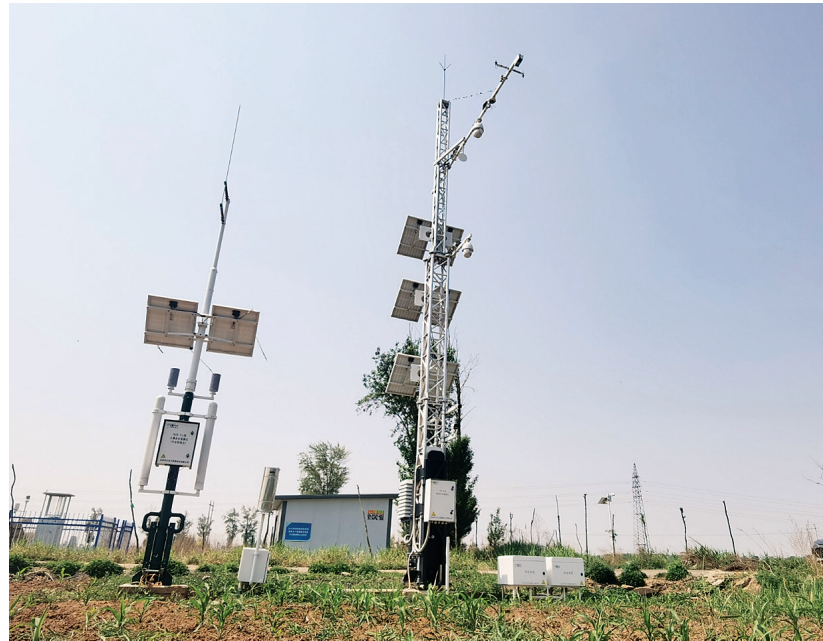
图为土壤水分观测仪(左)与物候自动观测仪(右)。受访单位提供
