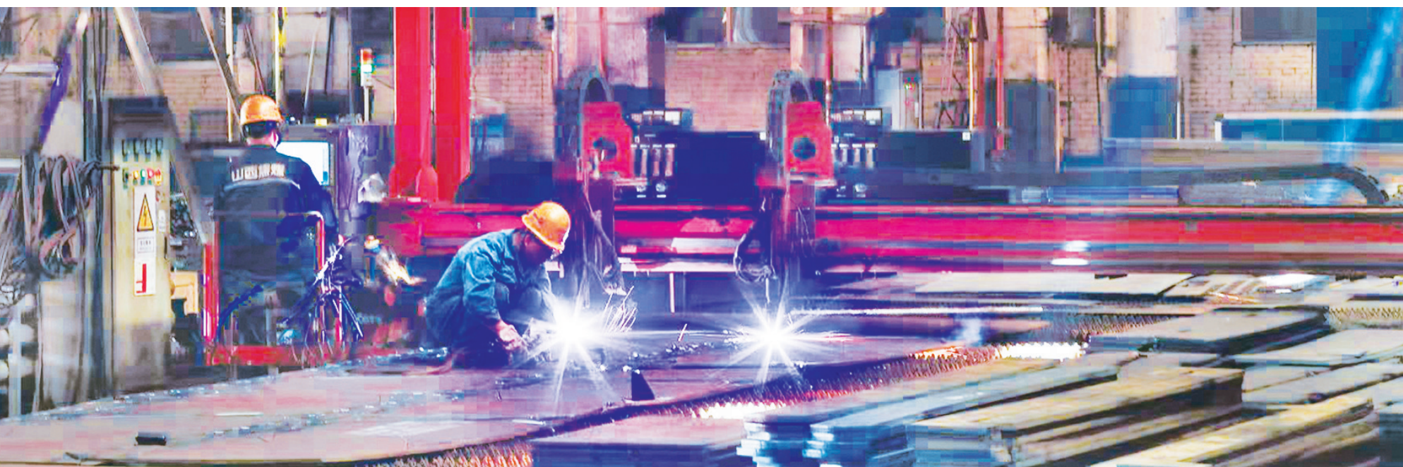
7月9日,山西焦煤西山机电厂车架制造车间数控组的技术工人正在进行等离子切割作业。该厂持续优化生产工艺,不断提升构件下料的精度与效率,为后续工序提供标准化的基础构件,为高品质液压支架生产提供可靠保障。王韵菲 摄
