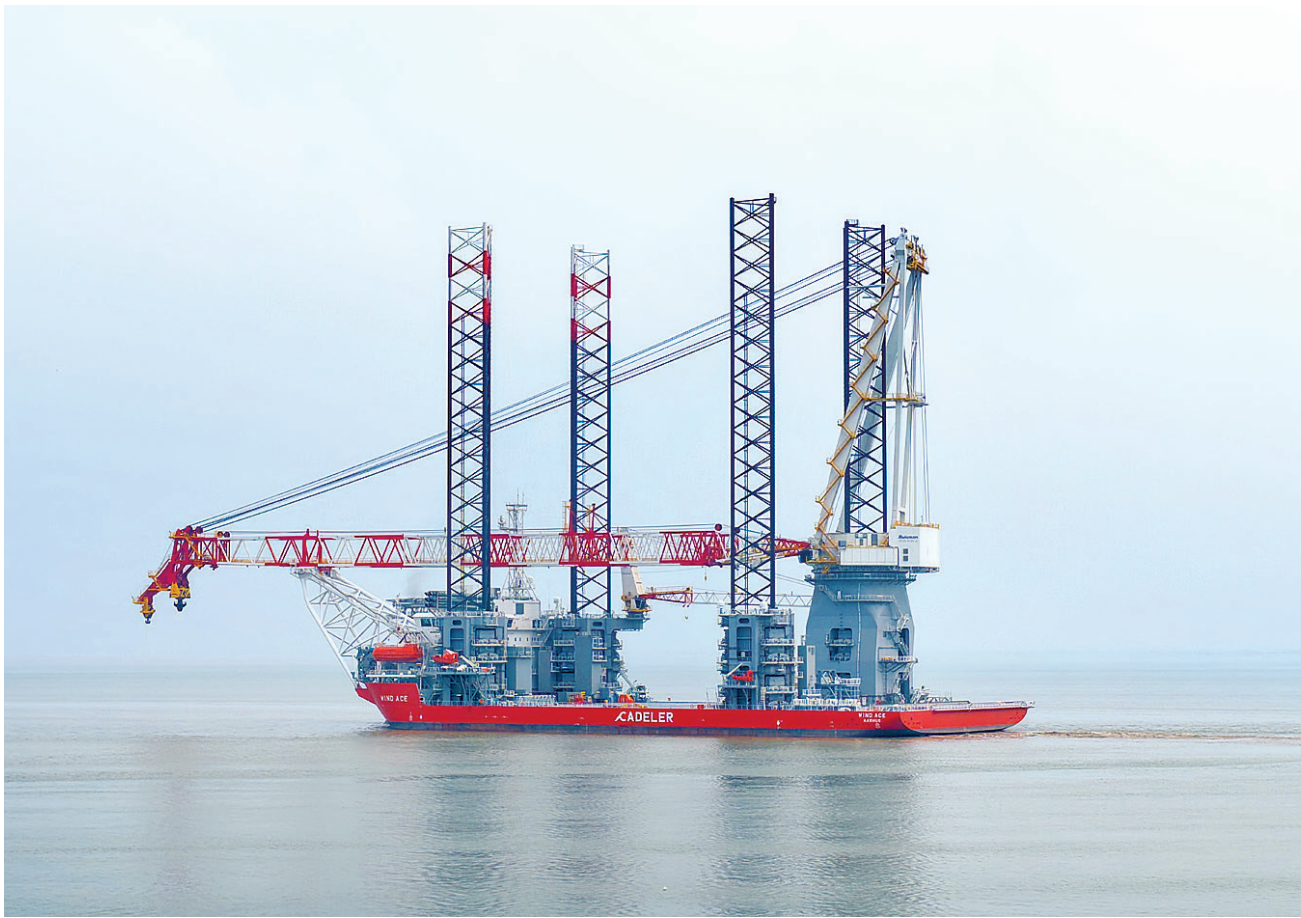
7月21日,NG20000型风电安装船“峰盛”号在江苏启东正式交付启航(无人机照片)。 7月21日,启东中远海运海工为丹麦船东定制的NG20000型风电安装船“峰盛”号正式交付启航。该船拥有超过5600平方米超大甲板、17600吨有效载荷、大于3300吨吊起重能力,可精准安装20兆瓦级以上超大型风机。 新华社发(许丛军 摄)
