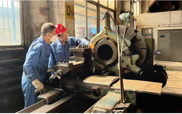
有色金属分厂职工在进行铜螺母的加工。
