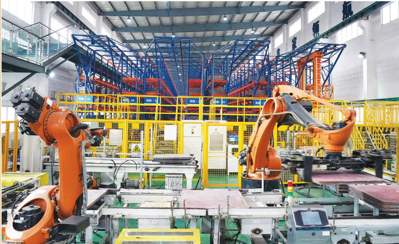
在江铜集团贵溪冶炼厂智能化电解车间,机器臂进行铜板转运作业(2026年1月21日摄)。 新华社记者 万象 摄
