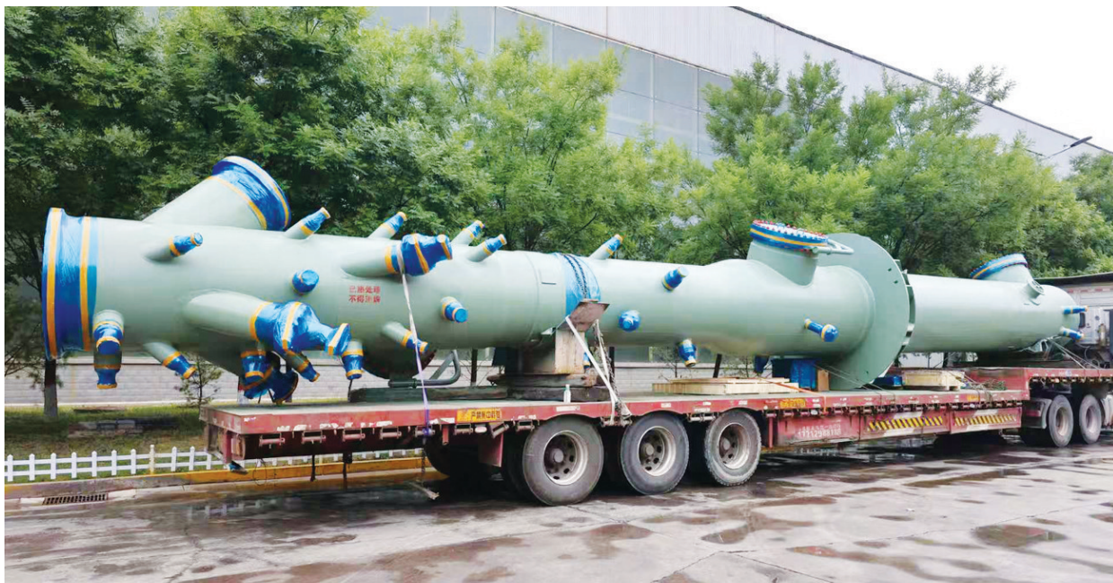
图为准备启运的潞安化机为中国化学工程东华工程科技股份有限公司生物质气化项目承制的核心装备“东华炉”。
