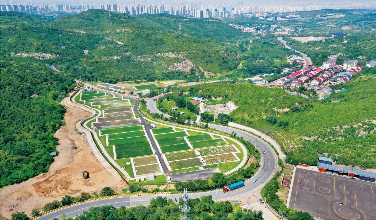
8月6日，杏花岭区北沙河复流水生态工程进行试运行。作为“一泓清水入黄河”配套项目，该工程新建数十个长方形人工潜流湿地单元格，通过植物根系吸附、微生物降解及基质过滤逐级净化等方式，实现对达标再生水的深度净化并注入北沙河，日处理量达3.6万立方米。
