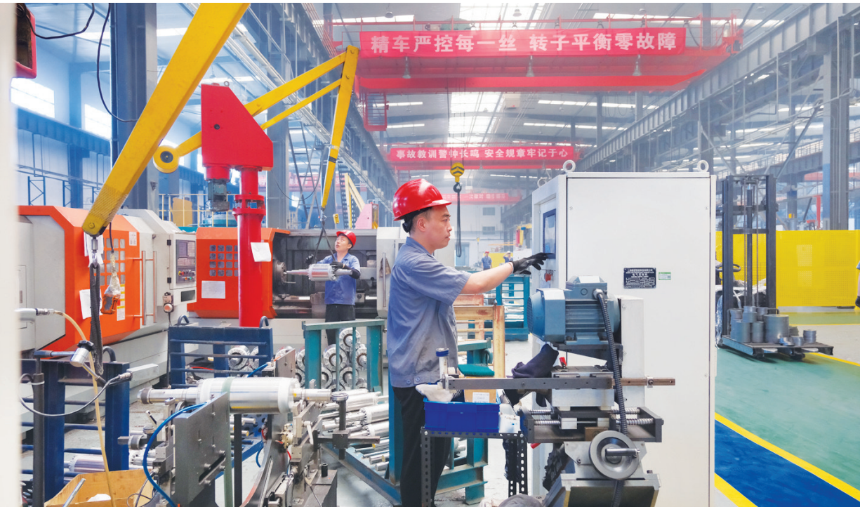
8月10日，山西电机制造有限公司转子分厂生产车间内，工作人员正在进行电机转子动平衡测试。该企业以精细作筑牢品质根基，持续发力高端电机制造，助推装备产业提质增效。 王韵菲 摄
