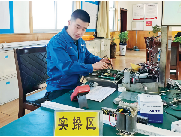
刘洋正在对单轨吊机车变频器开展检修维护，排查电气故障。（图片由受访者提供）
