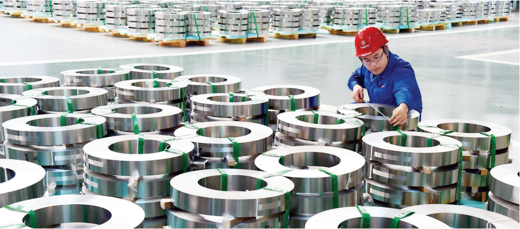
8月31日，在山西转型综改示范区入区企业山西太钢不锈钢精密带钢有限公司生产车间，技术人员仔细核验产品尺寸精度。该企业攻克技术难关，实现高温超导基材全流程国产化突破。该产品具备超薄、高平整度等优良特性，应用于国产核聚变装置、输电设施，相关国产超导材料还远销欧美市场。 王韵菲 摄
