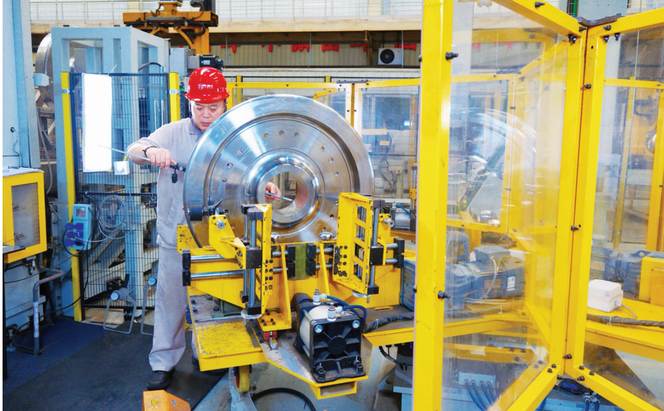
9月14日，太原重工轨道交通设备有限公司车轮厂二线检测线上，工作人员正在对车轮开展目视检测作业。该企业坚持高标准检验流程，保障轨道交通装备安全可靠。王韵菲 摄
