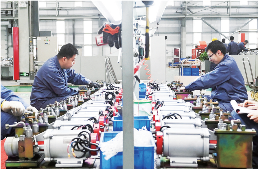
1月24日,中北高新区京丰公司轨道交通电务装备制造基地装配车间,工人正有序作业。近年来,该企业不断技术创新,将产品广泛应用于高铁、重载、地铁、城轨等领域,是我国唯一的ZY系列道岔转换设备生产厂家。年生产电液转辙机达到了10000组,成为走在世界前沿的“独角兽”企业。
