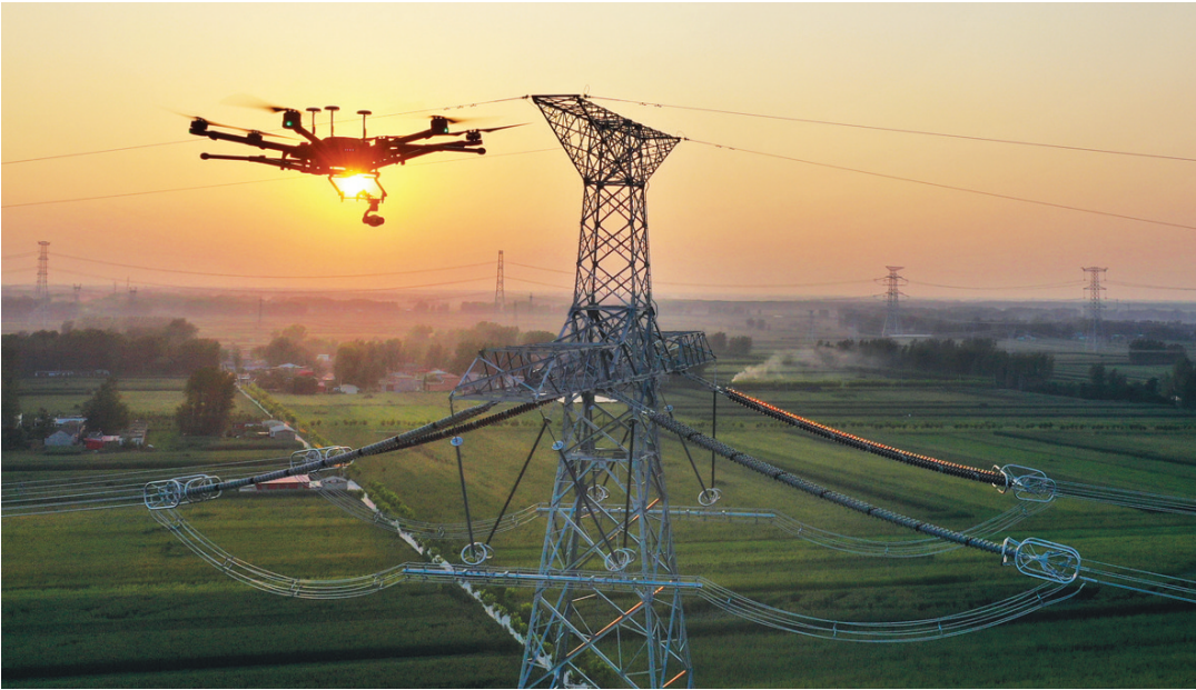
基于5G网络传输条件下的无人机在青海——河南±800千伏特高压直流输电工程豫南换流变电站外巡检（2020年8月27日拍摄，无人机照片）。 新华社 发
