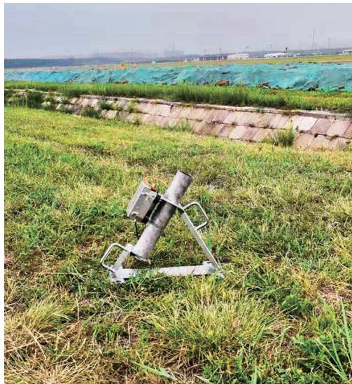
本报讯(记者 李涛 通讯员 仙博 文/摄)飞机在低空飞行时有可能撞上飞鸟,造成严重的安全隐患。8月4日消息,太原机场在驱鸟作业中新用上一种便携式钛镭弹发射器,可以通过电控击发、腾空炸响,产生声、光、振动和气浪冲击,以达到实时驱鸟目的。
