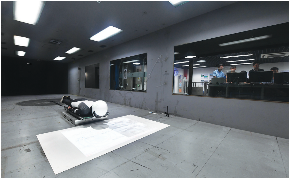
北京交通大学风洞实验室研究团队成员通过风洞辅助训练系统进行风洞测试。该系统能够应用于冰雪项目运动姿态优化、强化训练及高性能运动装备研发(2021年7月16日摄)。
