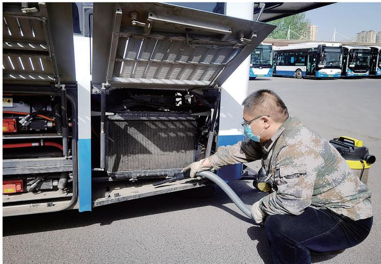
又到飞絮季节,漫天飞舞的杨絮柳絮不仅扰人,也容易堵塞公交车的散热器和车内易燃物报警系统。4月22日起,公交三公司修保车间开展专项行动,集中清理了纯电动公交车空气压缩机散热器和易燃物检测口周围的杂物,切实消除飞絮对车辆安全运行带来的影响。
