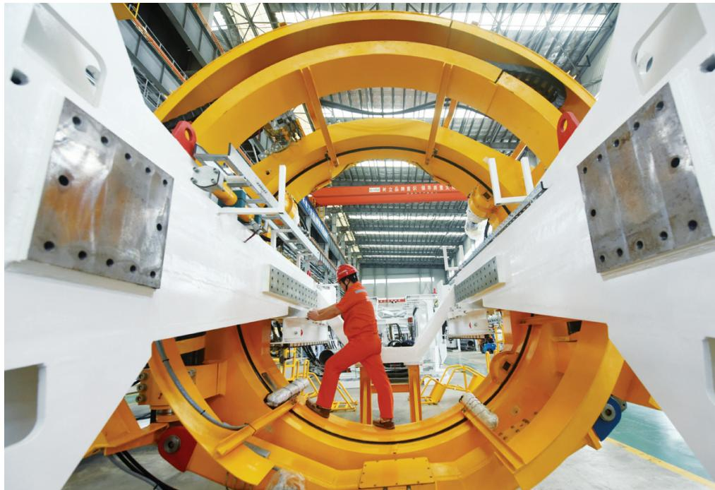
6月27日，浙江中铁装备位于杭州市萧山区的盾构机生产基地，工人安装新型盾构机的部件。
