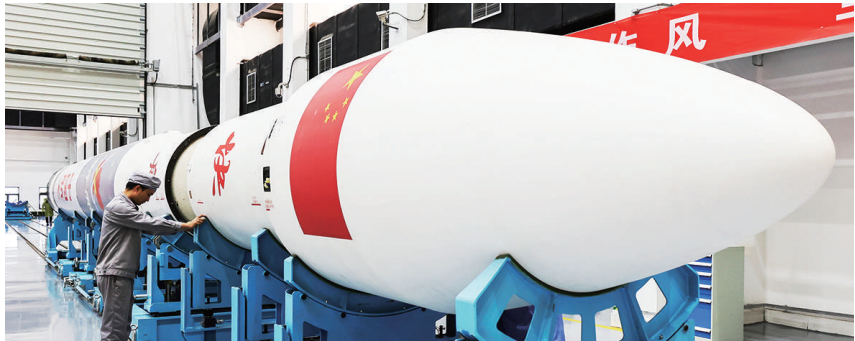
在武汉国家航天产业基地火箭产业园总装测试厂内，技术人员在对一发射火箭进行舱段对接状态检查(2022年7月15日摄)。 新华社 发
