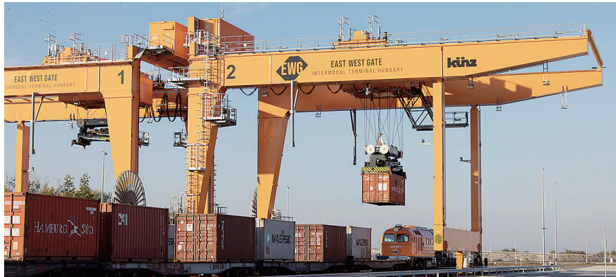
10月18日,由5G技术远程控制的龙门起重机在匈牙利费涅什利特凯的东西门场站搬运集装箱。新华社发
