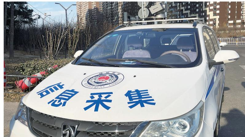
别物体精度高等优势。进入车载智能平台后,该系统可通过采集车,将拍摄到的道路病害问题,自动识别分析传输至城市运管服平台,完成案卷自动上报,实现闭环流转处置。
