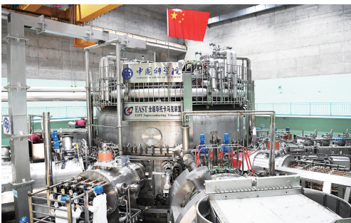
在中科院合肥物质科学研究院,工作人员对有“人造太阳”之称的全超导托卡马克核聚变实验装置(EAST)进行升级改造(2021年4月13日摄)。
