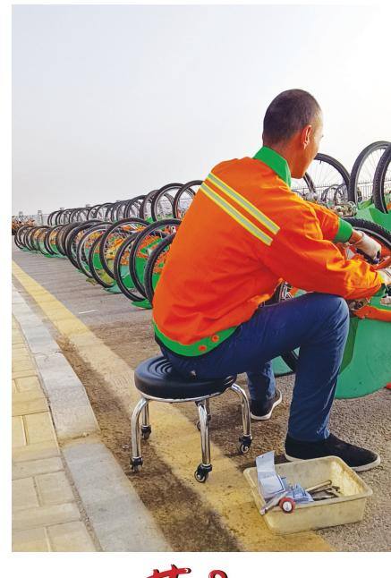
目前，4.1万辆公共自行车正在春季保养中。太原公共自行车公司二车队修理工郭仁杰利用废弃轴承，自制了“移动板凳”，极大提高了工作舒适度和保养效率。
