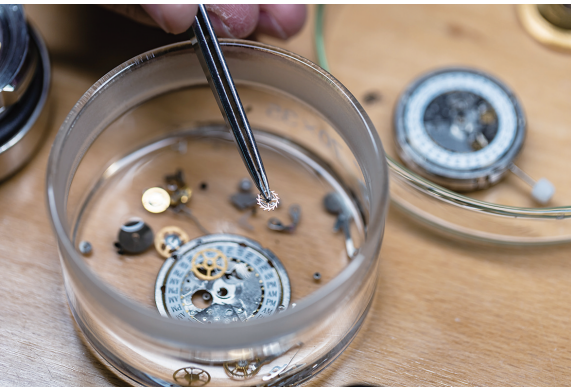
刘中华清洗手表拆下的零件。
