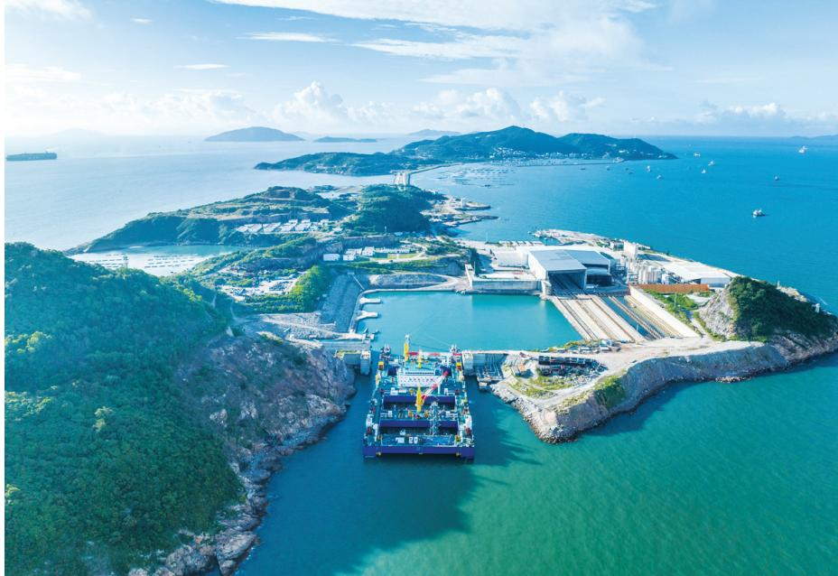
“一航津安1”号沉管运输安装一体船拖带E23管节和最终接头从珠海桂山岛启航，前往沉放水域。
