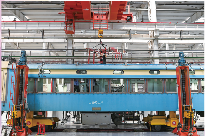
6月20日,工作人员在天车的配合下对货运机车进行检修。
