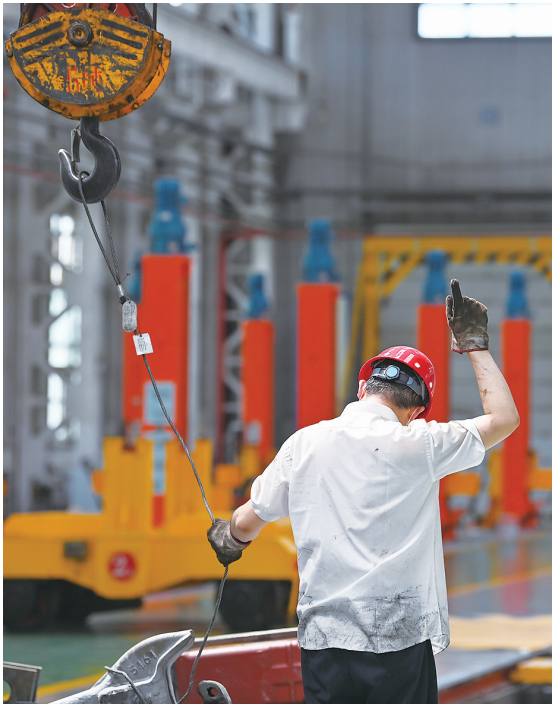
工作人员固定好部件后提示天车司机开始吊运。
