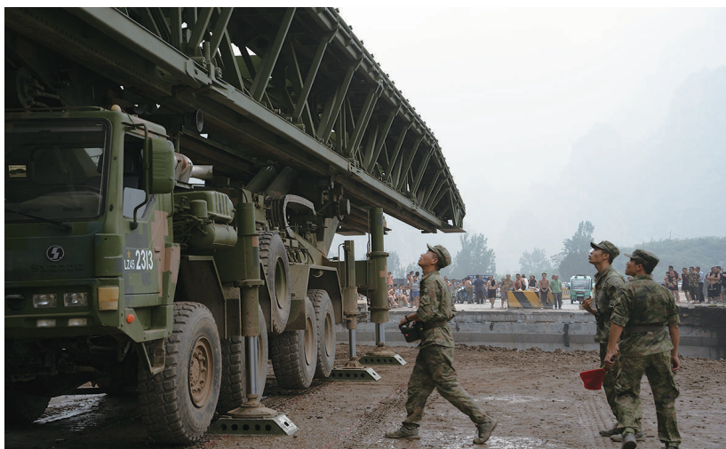
8月3日,中部战区陆军第82集团军某旅在北京市房山区涑宝路四渡桥断桥处架设桥梁,官兵们在对接桥体。
