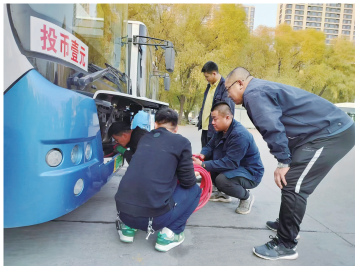
图为公交修理工正在用自制的充气导气管维修车辆。
