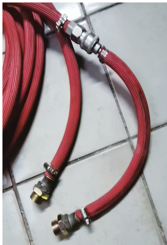
图为公交修理工自制的充气导气管。
