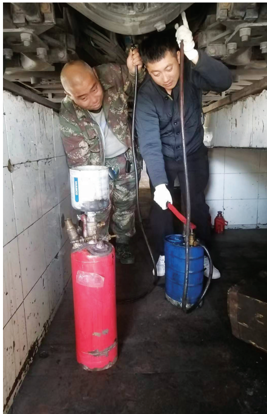
图为公交修理工用自制的充气换油装置维修车辆。
