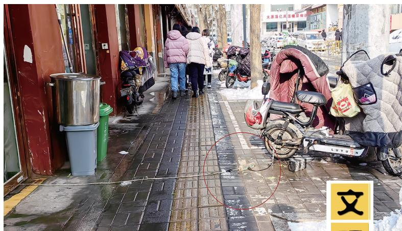
12月11日中午，精营西二道街路西，一家商户将电线从商铺拉出，为停在便道的电动自行车充电，而插线板则随意扔在湿漉漉的地面上。线缆拦路容易绊倒行人，更有漏电危险，存在安全隐患。在此，希望广大市民安全充电，共同营造安全、畅通的出行环境。
