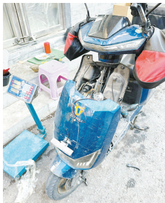
在一处修车摊前，摊主拆开电动车前面板，准备更换强光灯。
