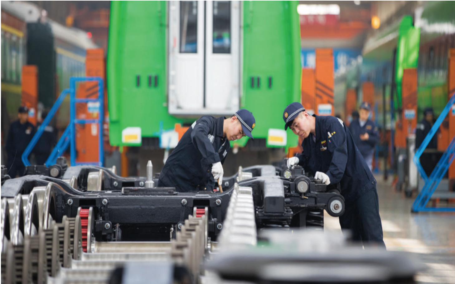
郭建、郭康正在相互配合，共同对刚刚组装完毕的转向架进行检查复验。
