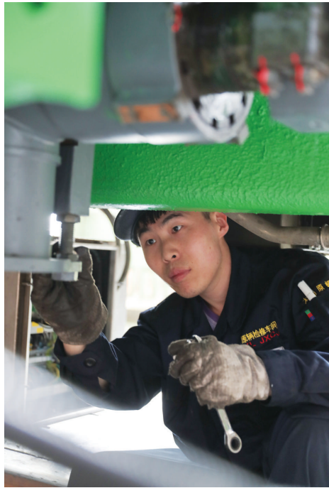
郭康正对“绿巨人”动车组钩高进行调整，确保后续动车车厢连接安全。
