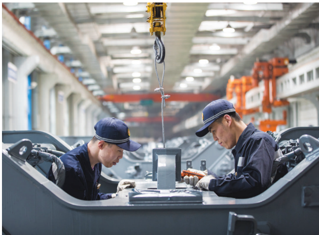
郭建、郭康正在使用自主研发制作的新工装吊具，组装“绿巨人”动车组转向架牵引体等部件。
