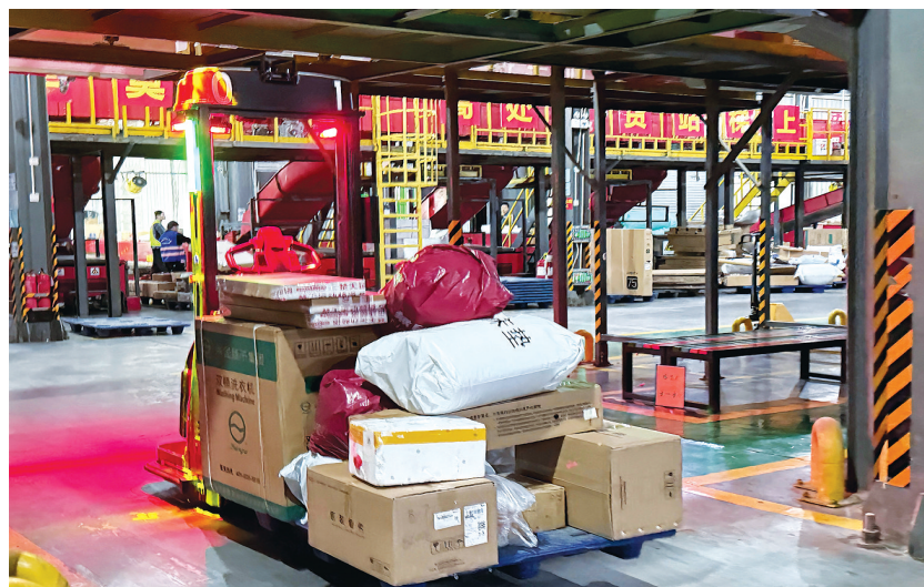
图为快递新投用的AGV智能搬运机器人
