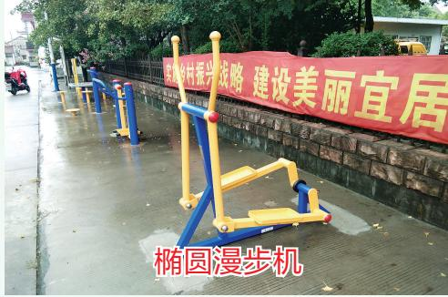
健身房椭圆机的小区“低配版”,它也是通过手脚联动的方式让双脚在踏板上形成椭圆轨迹。这样的运动非常接近跑步的动作,但相比跑步对膝关节和踝关节的冲击要小得多。
